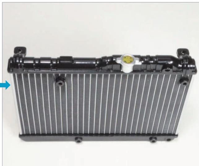
對準散熱器蓋 47-F 突起部分的形狀，然後插入 47-G 上的洞孔。
