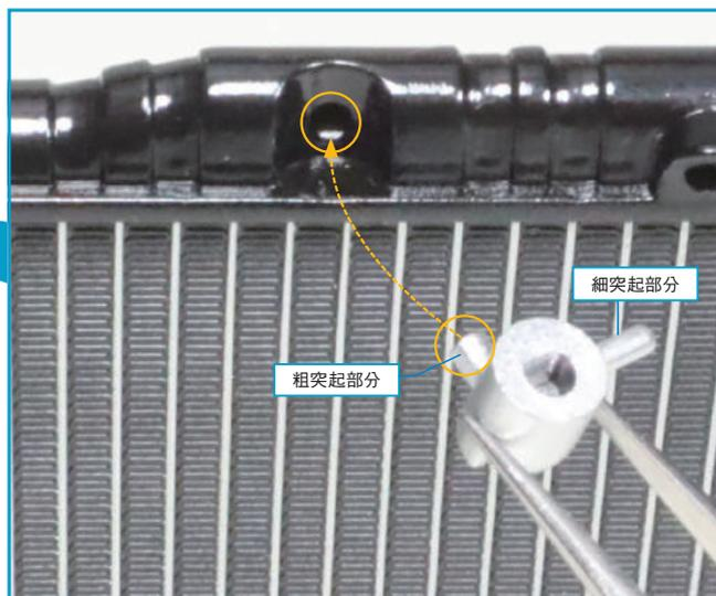
將在步驟 4 中組裝好的散熱器翻轉過來，把散熱器蓋支架 47-G 的粗突起部分插入 47-D 的洞孔中。
