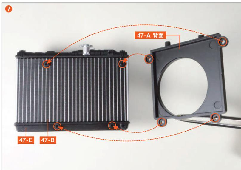
將風扇罩 47-A 的螺絲孔對準 47-B 和 47-E 的螺絲孔突起部分，然後嵌入。
